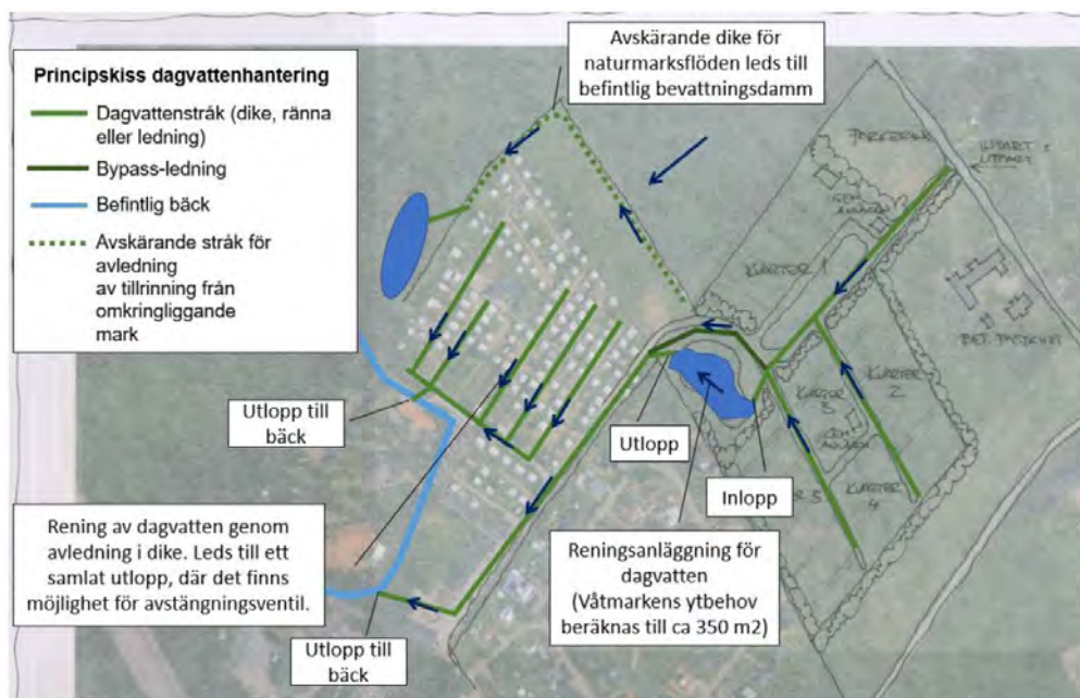
Figur 15 Förslag till dagvattensystem för planområdet (SWECO, 2020)
