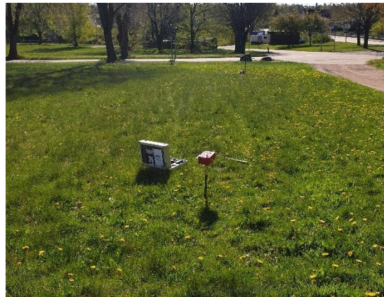
Figur 4. Mätning av radon i jordluft med MARKUS 10.
