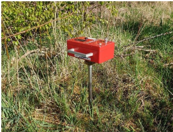
Figur 3. Mätning av radon i jordluft med MARKUS 10.
