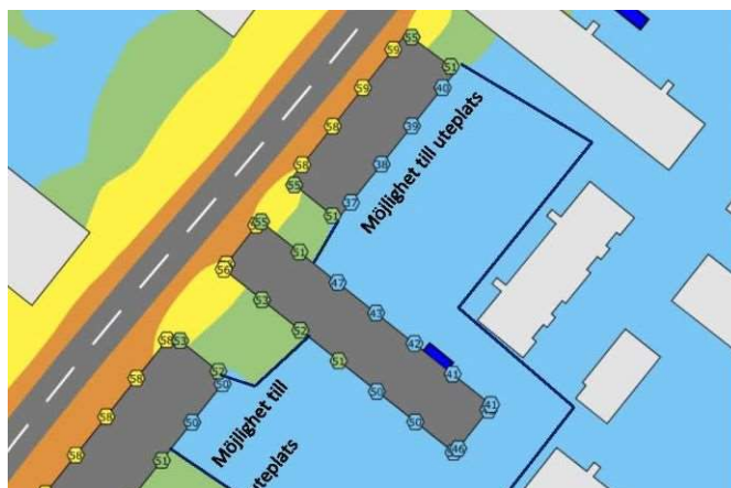
Bild 10. Utdrag från bullerutredningen, Dagnysekvivalent ljudnivå vid fasad. Källa: Bullerutredning, 2023-08-28, Efterklang
