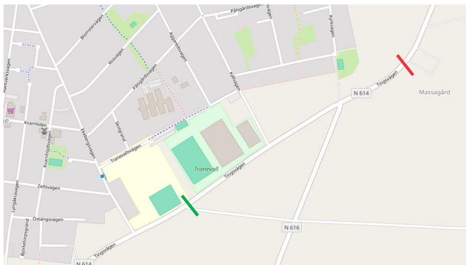
FIGUR 4. RÖD LINJE VISAR VAR HASTIGHETEN PÅ VÄGEN ÄNDRAS FRÅN 40 TILL 70 KM/H I DEN ALTERNATIVA BERÄKNINGEN. GRÖNT STRECK VISAR HASTIGHETSÖKNINGEN FRÅN 40 TILL 70 KM/H I DAGSLÄGET
