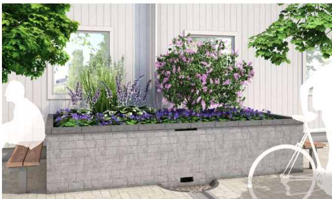
Figur 27. Upphöjd regnbädd. Nederbörden leds in i regnbädden via ett stuprör. Dagvatten leds ut i botten på anläggningen. Illustration: Tengbomgruppen.
