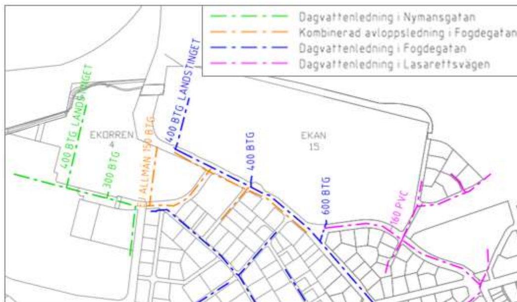
Figur 11. Befintliga kombinerade och dagvattenledningar runt planområdet.
