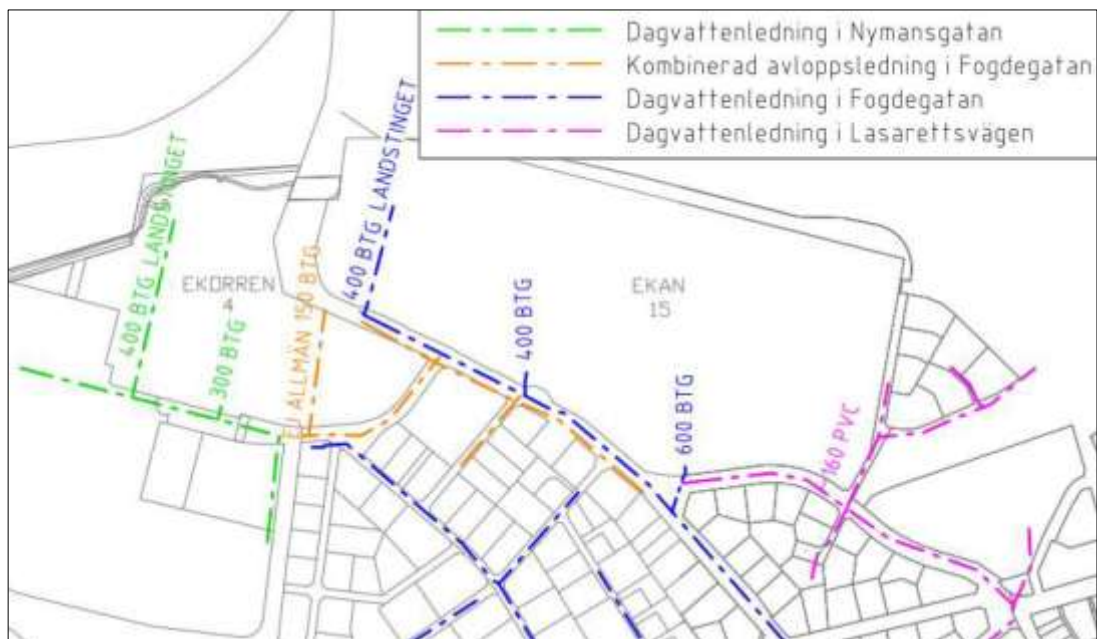
Figur 9 Befintligt ledningssystem inom planområdet (Sweco 2019).
