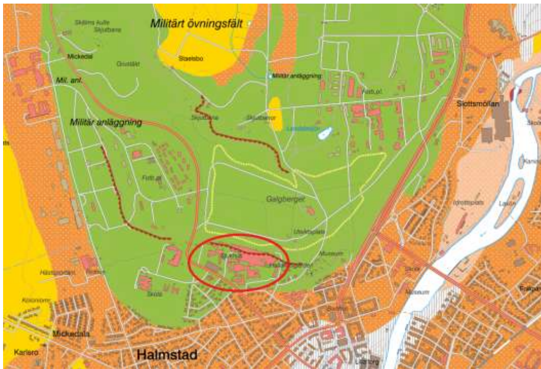
Figur 10. Jordartskarta från SGU (utklipp från kartgeneratören). Grönt = isälvs sediment, orange = sand, ljus orange = svallsediment, gult = lera. Sjukhusområdet markerad med röd elips.
