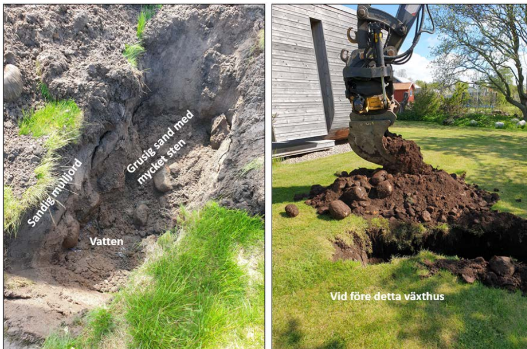
Figur 7. Till vänster jordlagerföljd i PG21-06 (delområde SP21-11 / S6). Till höger PG21-12 där fyllnadsjorden innehöll stora mängder sten samt inslag av glas.
