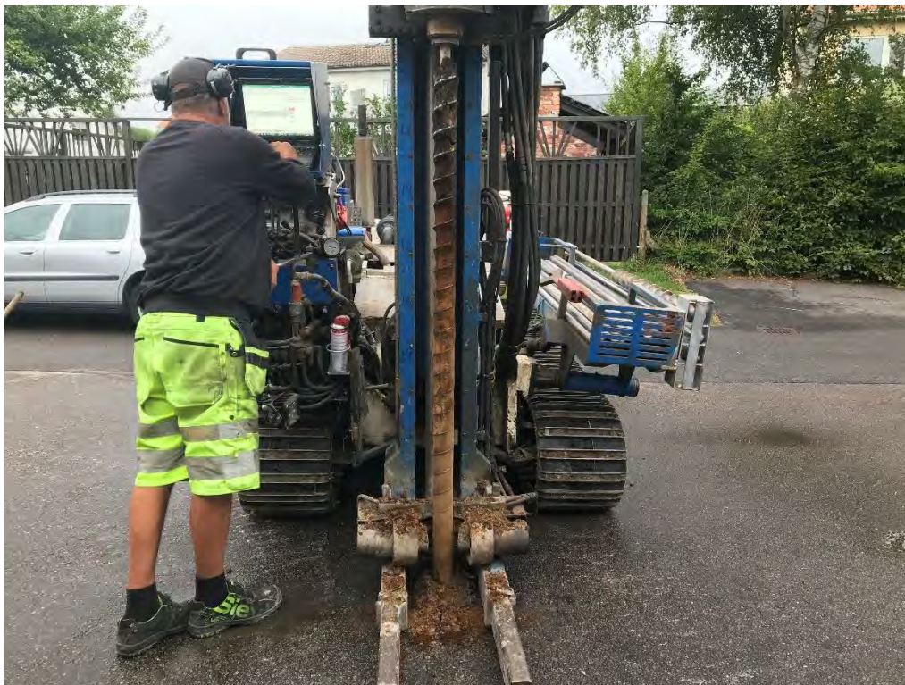
Figur 3. Jordprovtagning med geoteknisk borrhandsvagn vid provpunkt SKR2101.
