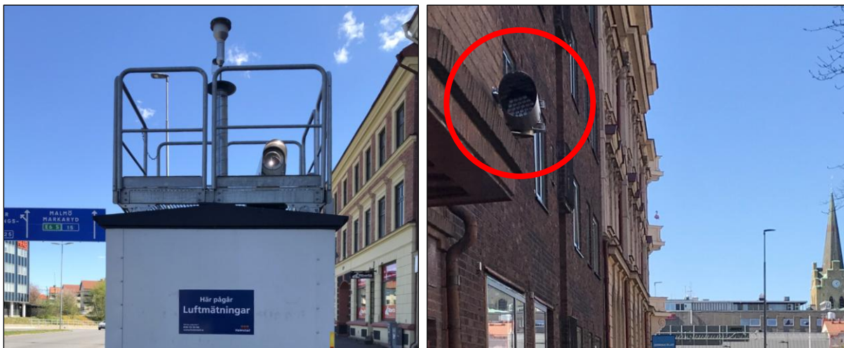
Figur 3.2 a-b. Mätutrustningen vid Viktoriagatan. Vänster bild: mäthuset med insug för partikelmätaren (högst upp mitt i bilden) och kombinerad ljussändare och -mottagare (till höger på takplattformen). Höger bild: ljusreflektor.
