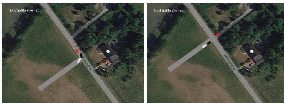
Figur 4. Trafiksituation som försämrar trafiksäkerheten om anslutningen inte anläggs vid in- och utfarten samt trafiksituation med god trafiksäkerhet.
