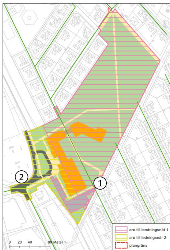
Figur 10. Uppskattade avrinningsområden. Rosa avrinningsområde (aro) avleds till ledningsnätet vid 1 och gult område avleds till ledningsnät vid 2.
