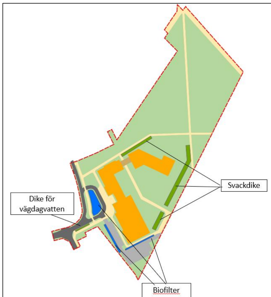
Figur 12. Möjlig placering av dagvattenanläggningar.
