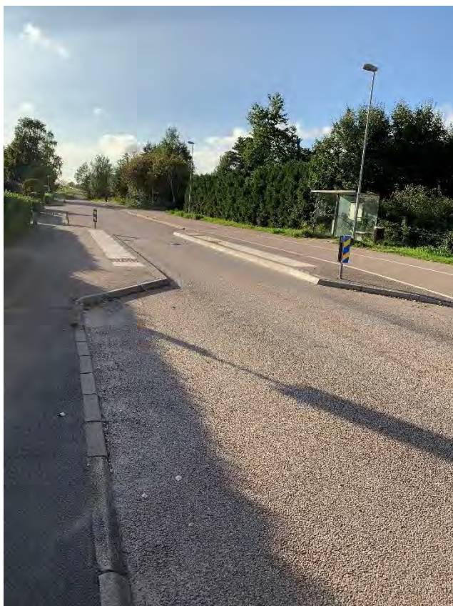
Figur 25. Exempel på timglashållplats som föreslås norr om Bäckavägen. Cykeltrafiken dras med fördel innanför hållplatsen på båda sidor.
